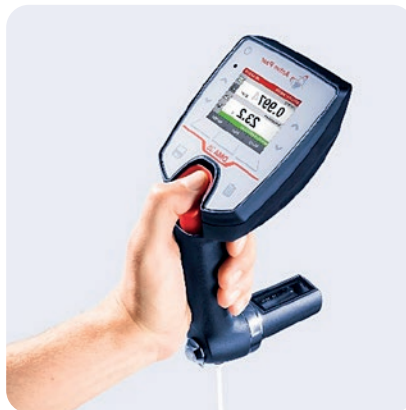
Densímetro portátil digital Leitura rápida e precisa da densidade do produto – em atendimento a ANP
