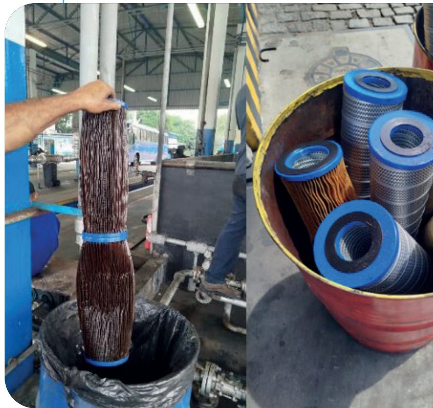
Programa da Qualidade do Diesel orienta sobre substituição de filtros saturados, entre outras questões que interferem no combustível
